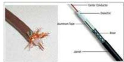
Los conectores que se suelen utilizar son el **BNC** y el tipo **N**. Dentro del cable coaxial existen diferentes estándares, dependiendo de su uso. Actualmente el cable coaxial no se utiliza para montar redes de ordenadores, si no para la distribución de las señales de Televisión, Internet por cable, etc.
