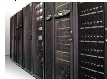
El superordenador Caléndula, gestionado por la Fundación del Centro de Supercomputación de Castilla y León, esta considerado como el más eficiente energéticamente de los instalados en España. Cuenta con 2800 procesadores, su memoria es de 8500 GB y tiene un rendimiento de 33000 GFlops.
